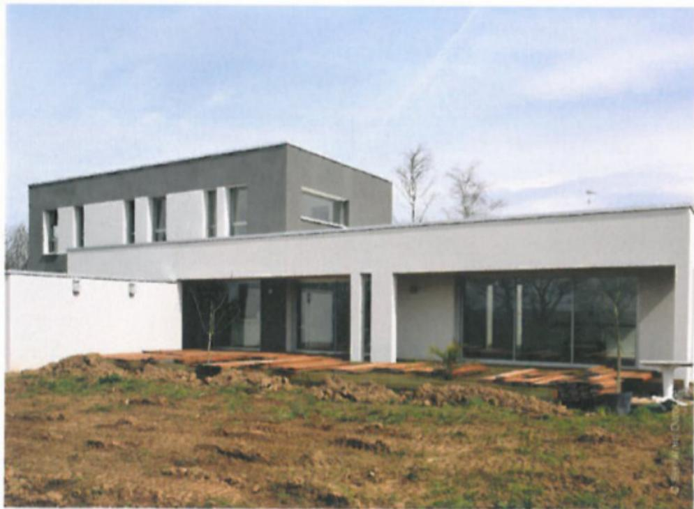
année 2009 / études 6 mois / travaux 12 mois / 249 m<sup>2</sup> SHON / structure maçonnerie, bois / bardage bois / couverture membrane d'étanchéité / menuiseries intérieures bois / menuiseries extérieures aluminium / sols carrelage / dispositifs énergétiques aérothermie, isolation renforcée
